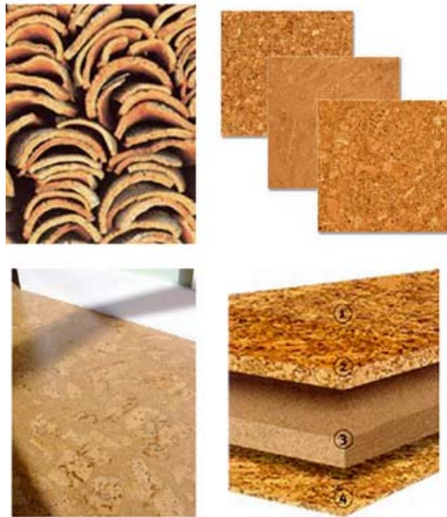
Kôra korkového duba a izolačné stavebné výrobky z korku
