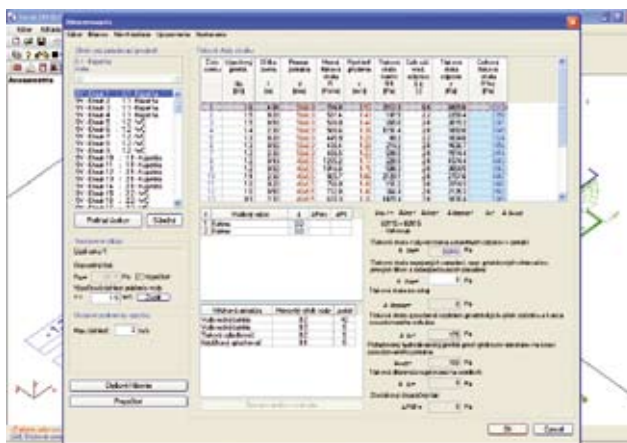
Obr.č.3: Dialógové okno dimenzovania vodovodu
