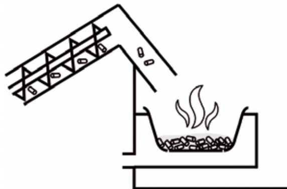
Obr. 8: Kúreniská so zhadzovaním paliva s ohniskovou panvou
