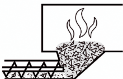
Obr. 1: Kúrenisko so spodným prívodom paliva
