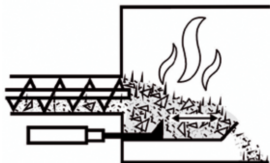
Obr. 7: Kúreniská s priečnym prívodom paliva nechladené
