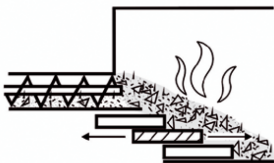
Obr. 5: Kúrenisko s priečnym prívodom paliva s posuvným roštom
