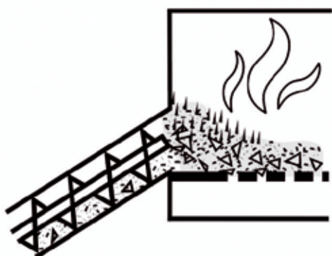
Obr. 4: Kúrenisko s priečnym prívodom paliva s pevným roštom
