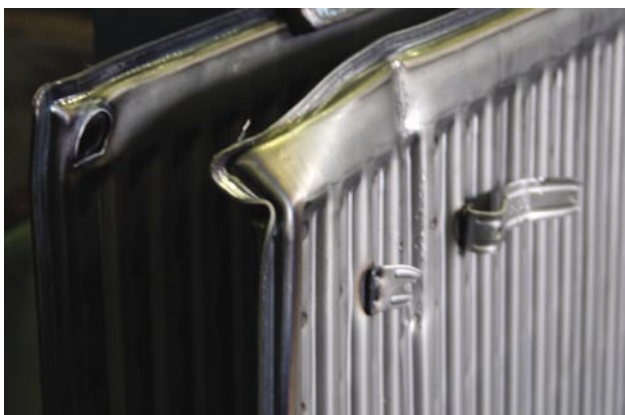
Obr. 1: Výsledok skúšky pevnosti zvarov
