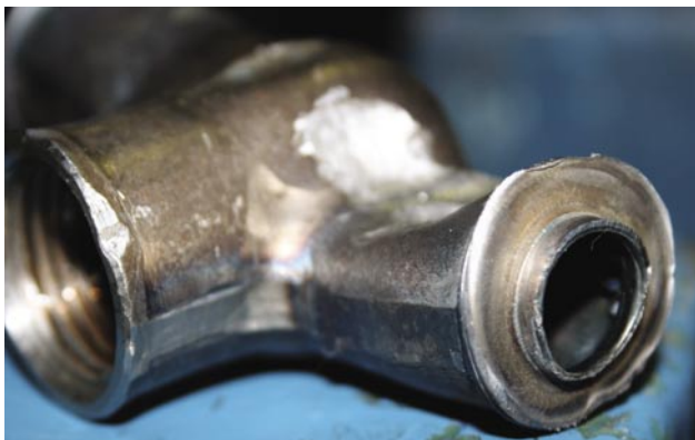
Obr. 2: Výsledok testovania pevnosti zvaru
