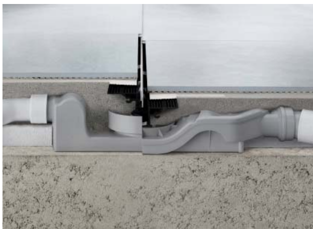
Doplňujúci model sprchového žliabku Advantix Vario (vpravo) potrebuje výrazne menšiu stavebnú výšku než štandardný model. Bol konštruovaný špeciálne pre sanácie a dokáže si poradiť i s nevýhodnými možnosťami pripojenia odtoku: odtok a odtokové koleno možno otočiť o 360°. (Foto: Viega)
