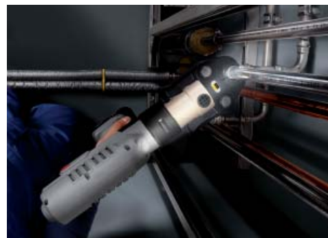
Integrované LED svetlo v Pressgun 5 poskytuje potrebný prehľad i na slabo osvetlených lisovacích miestach. (Foto: Viega)
