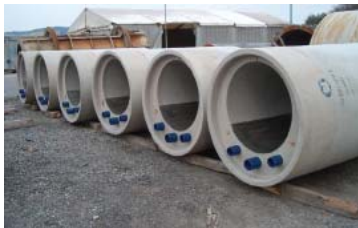
Obr.4: Integrovaný výmenník tepla v stene betónovej kanalizačnej rúry 1 - betónová rúra, 2 - prívod studenej vody do výmenníka, 3 - rozdeľovacie potrubie, 4 - výmenník tepla, 5 - výstup ohriatej vody z výmenníka [5]
