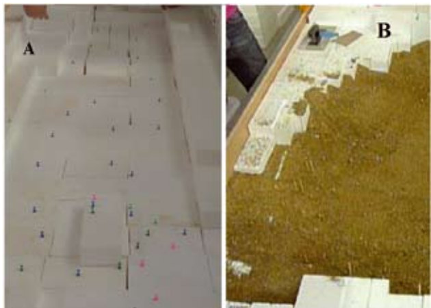
Obr. 3: A – Označovanie vrstevníc farebnými značkami. B – Aplikácia opakomatu na model.
