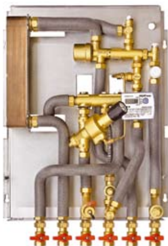
V pasívnych domoch sa uplatnili bytové stanice LOGOtherm, ktoré sa integrovali do inštalačných stien, aby sa ušetrilo miesto; pitná voda sa ohrieva prietokovým spôsobom
