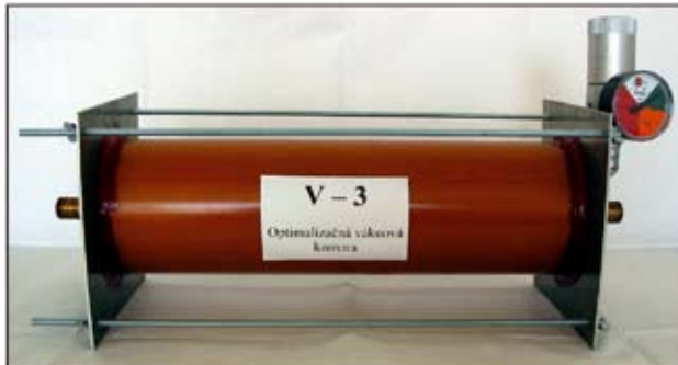
Obr. 3: Vákuová komora po vysatí vzduchu jednostupňovou vákuovou vývevou
