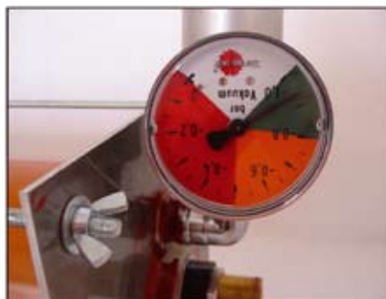
Obr. 4: Detail vákuometra po vysatí vzduchu z vákuovej komory V-3
