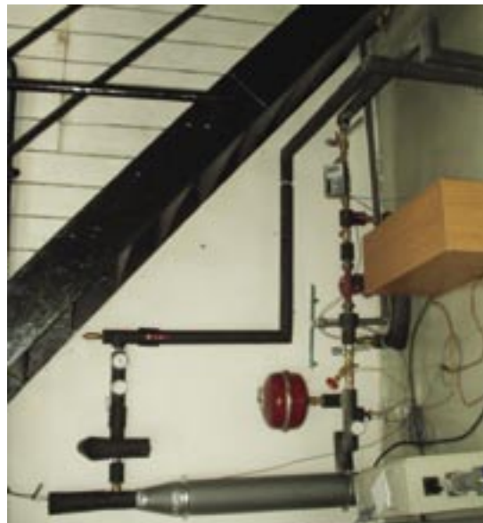
Obr. 2. Pohľad na merací okruh vykurovacieho telesa
