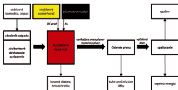
Obr. 3: Schematické znázornenie plazmového splynovania a tavenia odpadnej komodity [7]
