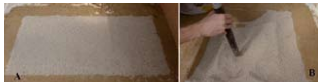
Obr. 11: A - Model bazéna naplnený perlitom, B - odsávanie perlitu z telesa bazéna
