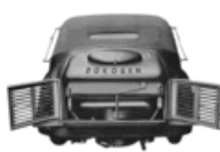
Škoda Superba z roku 1942, model s generátorem na dřevoplyn DOKOGEN
