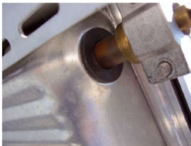
Obr. 1: Vyústenie potrubia z vane solárneho kolektora, kde pryžové tesnenie býva najčastejšie poškodené v dôsledku prehriatia kolektora.
