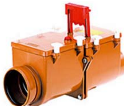
Obrázok č. 1: Automatický uzáver proti vzdutej vode s klapkou s ručným zaistením klapky a krytom na čistenie.
