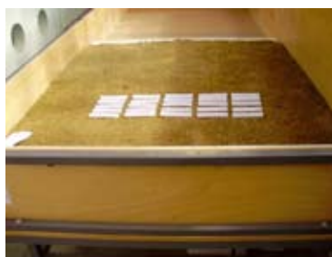
Obr. 1: Model fotovoltaickej elektrárne na rovnej ploche[4].
