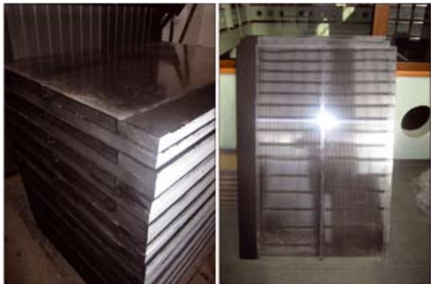
Obr.2: Dokončené kolektorové dosky pred zostavením fasády
