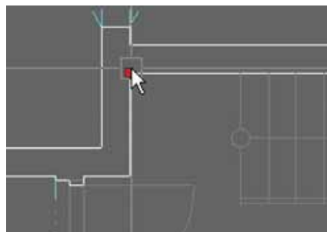
Obr. 2-1 Zadávanie plochy podlahového vykurovania.
