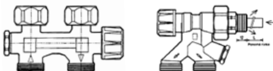
Obr. 3: ventily na pripájanie radiátorov pre jednorúrkové a dvojrúrkové sústavy
