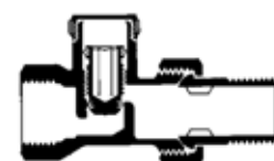
Obr. 4: radiát. šrúbenie priame pohľad a rez
